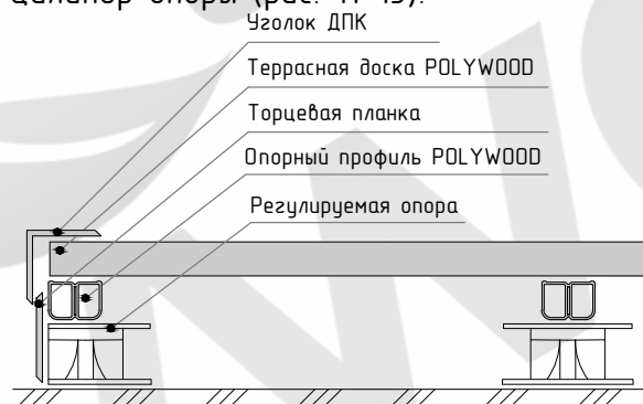
Рис.12 Монтаж с уголком из дпк
