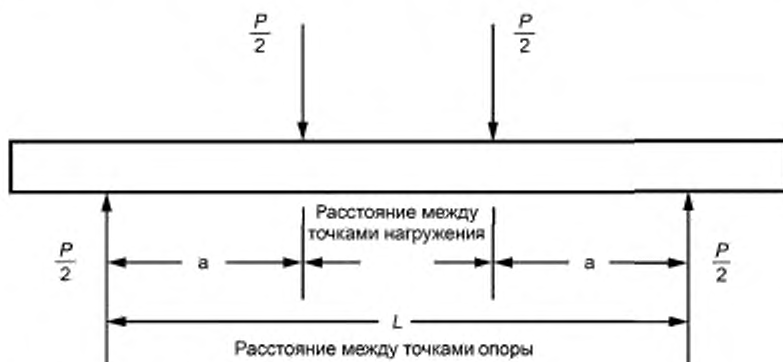
Рисунок X1.1 — Схема нагружения в случае расстояния между точками нагружения, не равного одной трети расстояния между опорами
