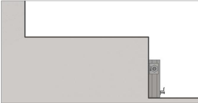
1. Монтаж опорной конструкции и концевой скобы
