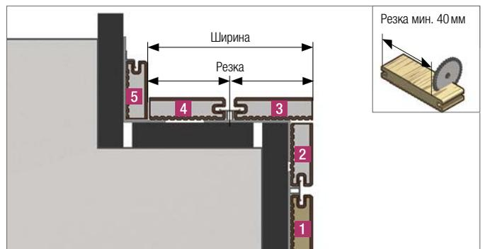
4. Расчет резки:  $\text{Резка} = (\text{ширина}/2) - 4 \text{ мм}$
