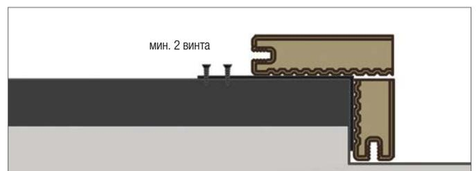
2. Крепление фиксирующего уголка с помощью опорной конструкции
