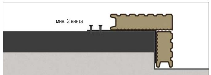
2. Крепление фиксирующего уголка с помощью опорной конструкции
