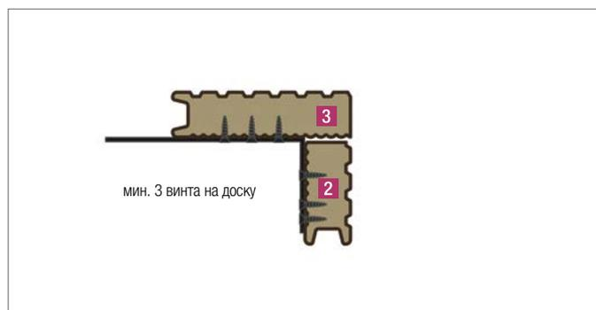
5. Крепление RELAZZO puro solid с помощью фиксирующего уголка
