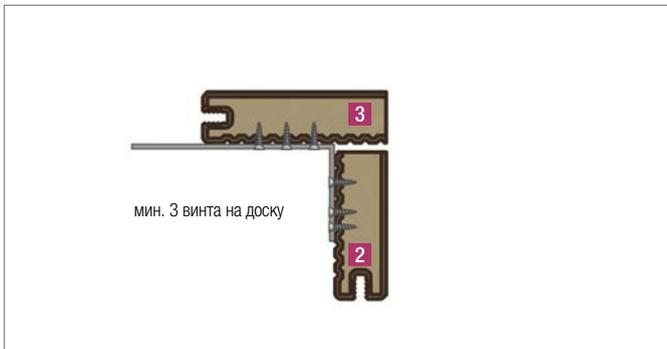
5. Крепление RELAZZO cogo с помощью фиксирующего уголка
