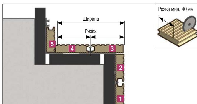
4. Расчет резки:  $Резка = (ширина/2) - 4\text{ мм}$
